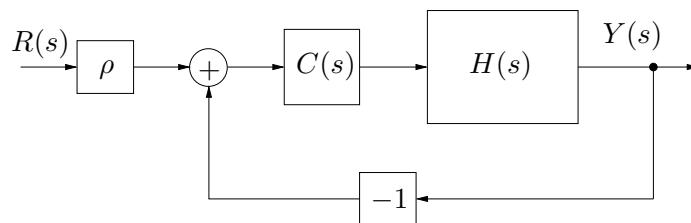
Determine um controlador próprio que aloque os pólos em malha fechada em  $-4$ ,  $-4$  e  $-4$ .
