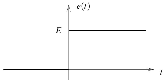
Como a função degrau vale **zero** no intervalo  $(-\infty, 0)$ , e o circuito é dissipativo, a tensão no capacitor em  $t = 0$  é **nula**.
