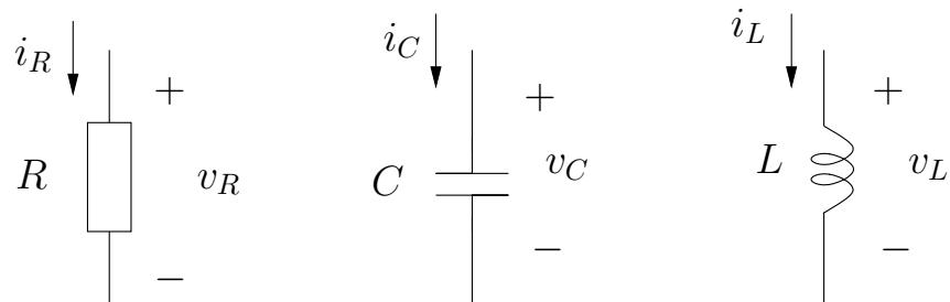
$$v_R = R i_R \quad i_C = C \frac{dv_C}{dt} \quad v_L = L \frac{di_L}{dt}$$
