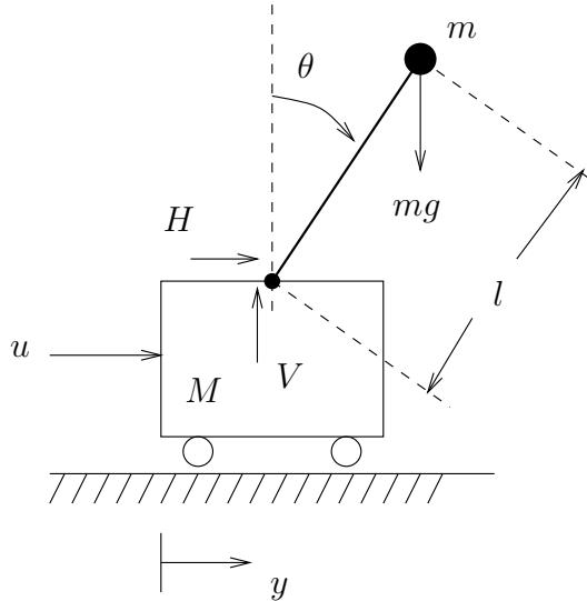
Assume-se que o movimento se dá no plano e desprezam-se o atrito e a massa da haste. O objetivo é manter o pêndulo na posição vertical (modelo simplificado do lançamento de um foguete espacial).
