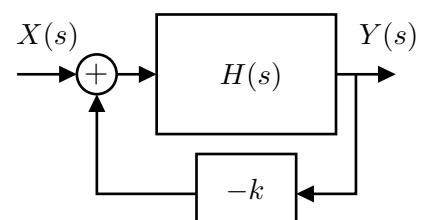
$$(j\omega)^2 - 8j\omega + 12 + k((j\omega)^2 + 8j\omega + 12) = 0 \Rightarrow k = 1, s = \pm j\omega, \omega = \sqrt{12}$$
