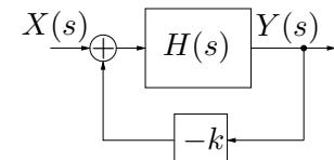
**10<sup>a</sup> Questão:** Determine, para o lugar das raízes do sistema realimentado mostrado na figura ao lado: a) Os cruzamentos no eixo real; b) Os valores de  $k > 0$  nos cruzamentos
