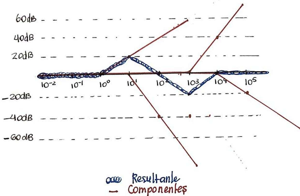
b)  $y_f(t) = ?$   $x(t) = \cos(\underbrace{10t}_\omega) + \sin(\underbrace{1000t}_\omega)$
