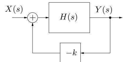
Esboce (nas folhas de papel almanaque) o lugar das raízes para o sistema realimentado (eixo real e assíntotas), determinando o ponto de encontro das assíntotas
