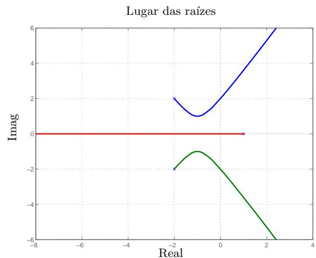
**10<sup>a</sup> Questão:** No lugar de raízes mostrado na figura, com pólos em  $1$  e  $-2 \pm 2j$ , determine o intervalo para o ganho  $k$  que garante a estabilidade do sistema em malha fechada.
