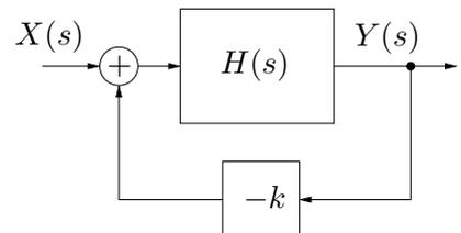
Esboce (nas folhas de papel almaço) o lugar das raízes para o sistema realimentado (eixo real e assíntotas), determinando o ponto de encontro das assíntotas
