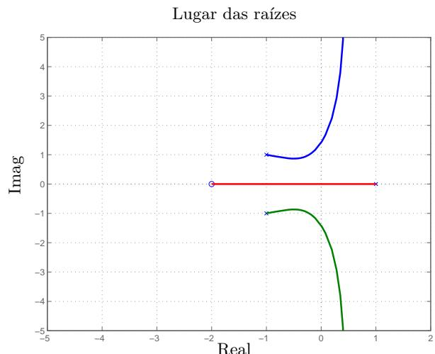
**10<sup>a</sup> Questão:** No lugar de raízes mostrado na figura, com pólos em  $1, -1 \pm j$  e um zero em  $-2$ , determine o intervalo para o ganho  $k$  que garante a estabilidade do sistema em malha fechada. Obs. Considere que os cruzamentos com o eixo imaginário ocorrem em  $0$  e (aproximadamente) em  $\pm 1.4j$ .
