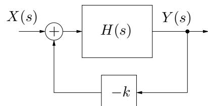
Esboce (nas folhas de papel almaço) o lugar das raízes para o sistema realimentado (eixo real e assíntotas), determinando o ponto de encontro das assíntotas
