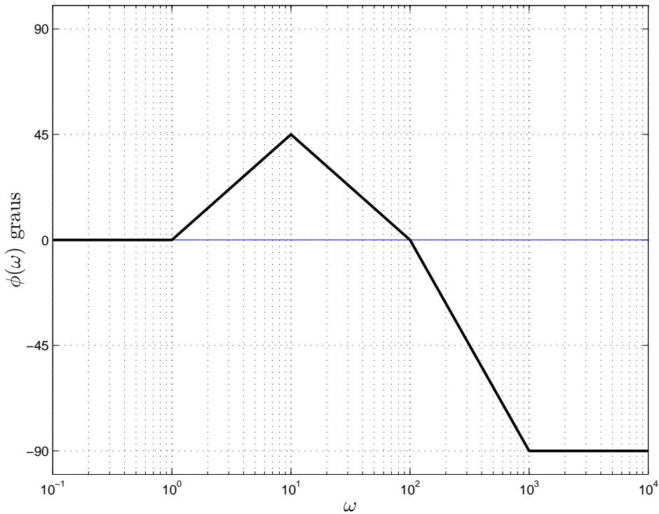
Sabendo que o valor DC é 0 dB, determine o diagrama assintótico de módulo (diagrama de Bode em escala logarítmica) do sistema.
