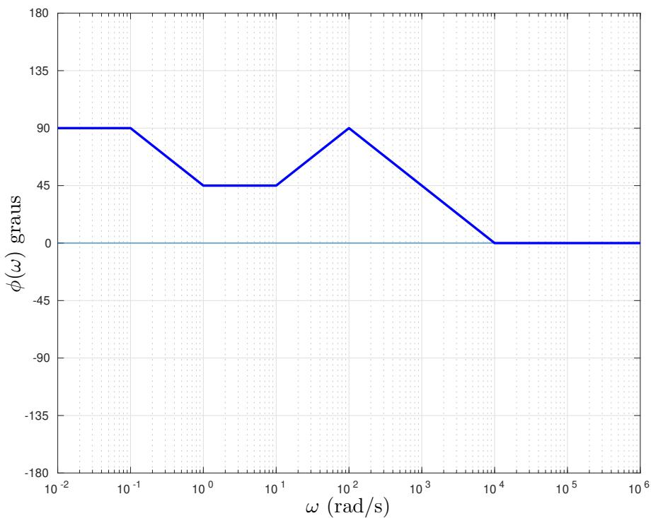
b) Baseando-se nos diagramas assintóticos de módulo e fase, determine a solução forçada do sistema para a entrada  $x(t) = 10 \cos(5t) + \sin(1000t)$
