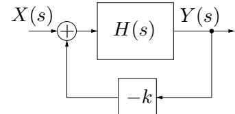
Esboce (nas folhas de papel almoço) o lugar das raízes para o sistema realimentado (eixo real e assíntotas), determinando o ponto de encontro das assíntotas
