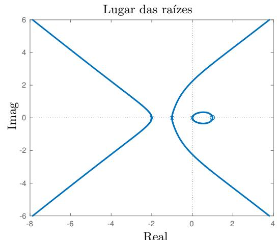
**10<sup>a</sup> Questão:** Usando a aproximação das assíntotas para o sistema realimentado mostrado na figura, determine o intervalo para  $k > 0$  que garante a estabilidade do sistema
