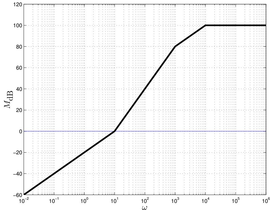
b) Baseando-se nos diagramas assintóticos de módulo e fase, determine a solução forçada do sistema para a entrada  $x(t) = 100 \cos(10000t)$
