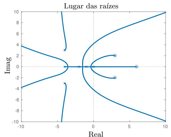
**10<sup>a</sup> Questão:** Usando a aproximação das assíntotas para o sistema realimentado mostrado na figura, determine o intervalo para  $k > 0$  que garante a estabilidade do sistema
