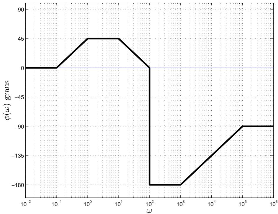
Sabendo que o valor DC do sistema é igual a 60dB, determine o diagrama assintótico de módulo (diagrama de Bode em escala logarítmica) resultante
