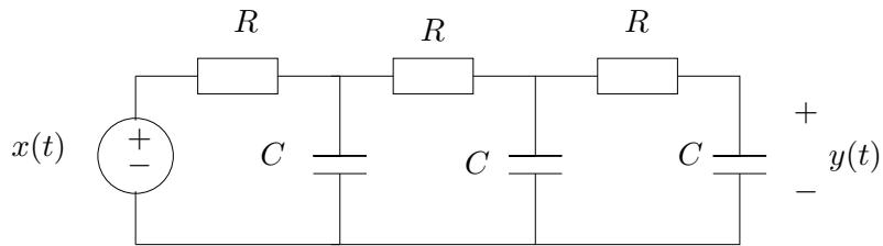
Determine o valor máximo do intervalo  $T$  entre amostras para que a saída do circuito  $y(t)$  seja recuperada sem erro a partir do sinal amostrado  $y(kT)$ .
